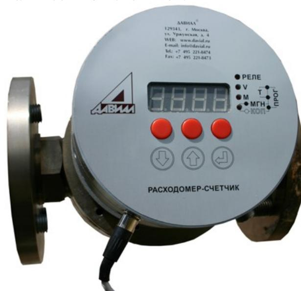
Массовые значения расхода определяются расчетным образом от объемного расхода с учетом плотности проходящего материала. Плотность материала задается в настройках прибора. Плотность автоматически корректируется с учетом температуры материала. Температура материала может быть фактически измерена либо задана в настройках прибора. Коэффициенты закона изменения плотности в зависимости от температуры также могут задаваться в настройках прибора.
