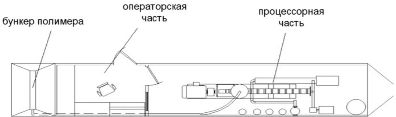
Бункер полимера изготовлен из нержавеющей стали и теплоизолирован, что обеспечивает комфортное хранение полимера и отсутствие конденсата при различных погодных условиях. Подача полимера в процессорную часть осуществляется посредством гибкого шнека, смонтированного под обшивкой контейнера.
